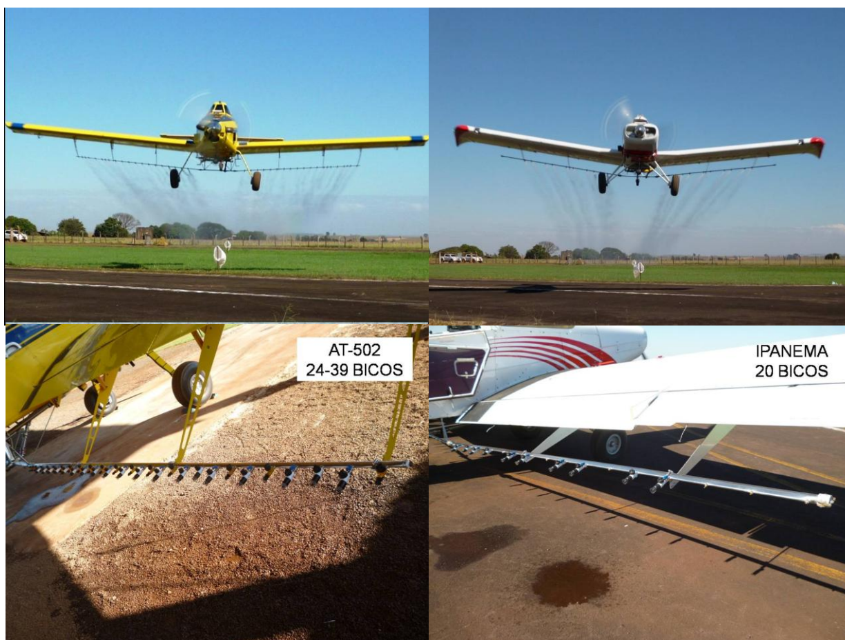
Figura 7. Aeronaves e arranjos de bicos utilizados na etapa de testes para avaliar espectro de gotas e perfil da faixa de deposição.
