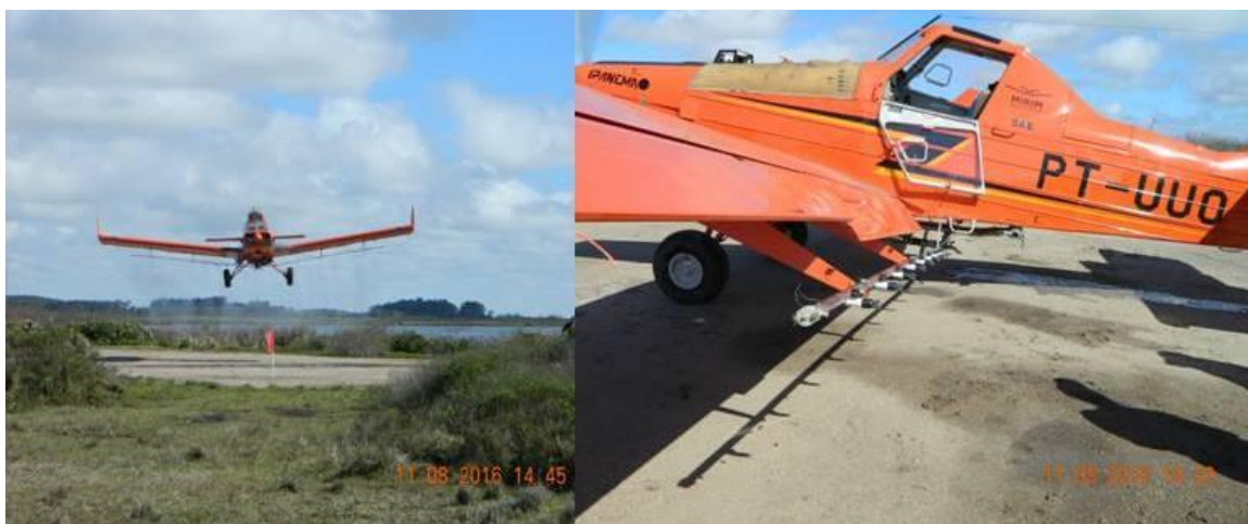
Figura 12. Aeronave Ipanema aplicando com bicos STOL ULD e detalhe do arranjo dos bicos na barra de pulverização.
