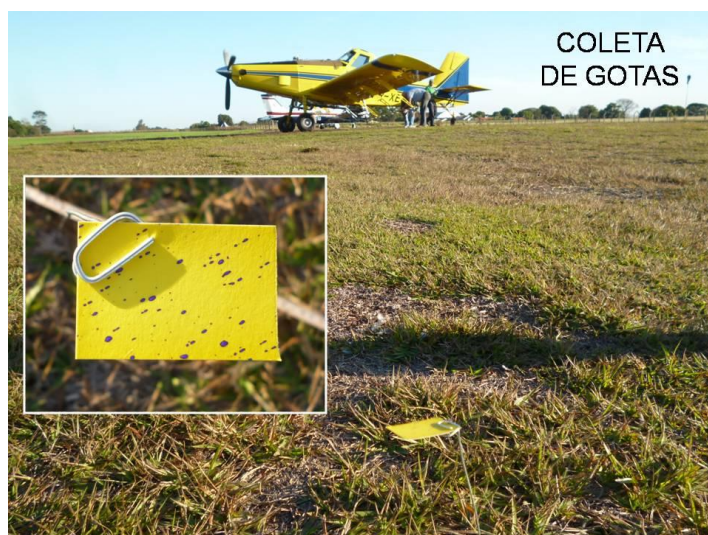
Figura 8. Posicionamento dos cartões de papel sensível à água para coleta de gotas.
