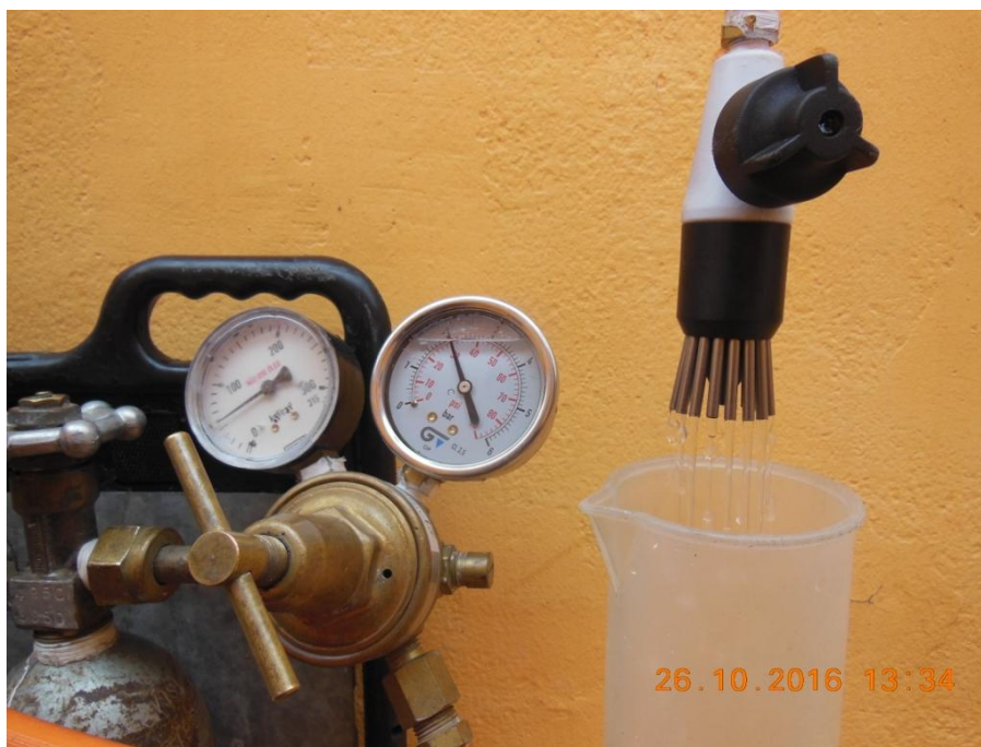
Figura 1. Bancada de testes para determinação da vazão dos bicos STOL ULD. Laboratório Schroder Consultoria, 2016.
