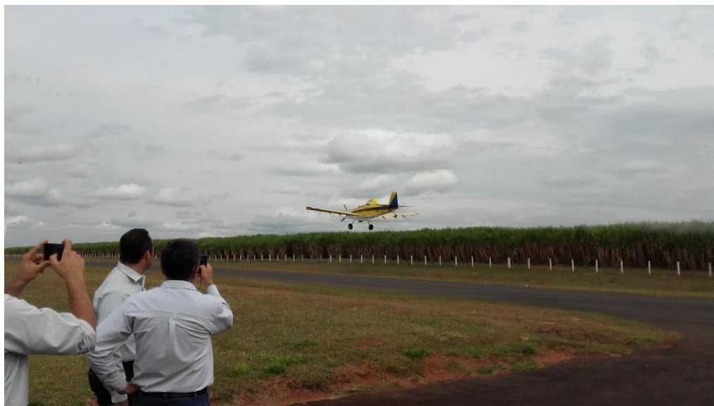
Figura 3. Aplicação de água 30 L/ha com bicos STOL ULD sobre canavial.
