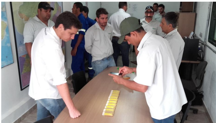
Figura 6. Avaliação visual do espectro de gotas dos bicos STOL ULD sobre cartões de papel sensível à água.
