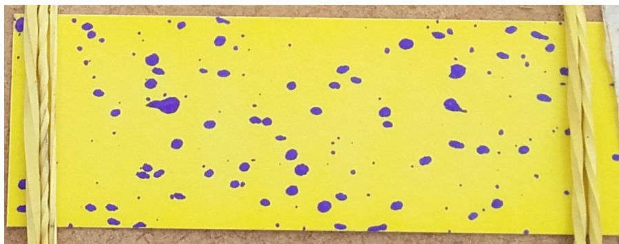
Figura 5. Espectro de gotas dos bicos STOL ULD sobre cartão de papel sensível à água.
