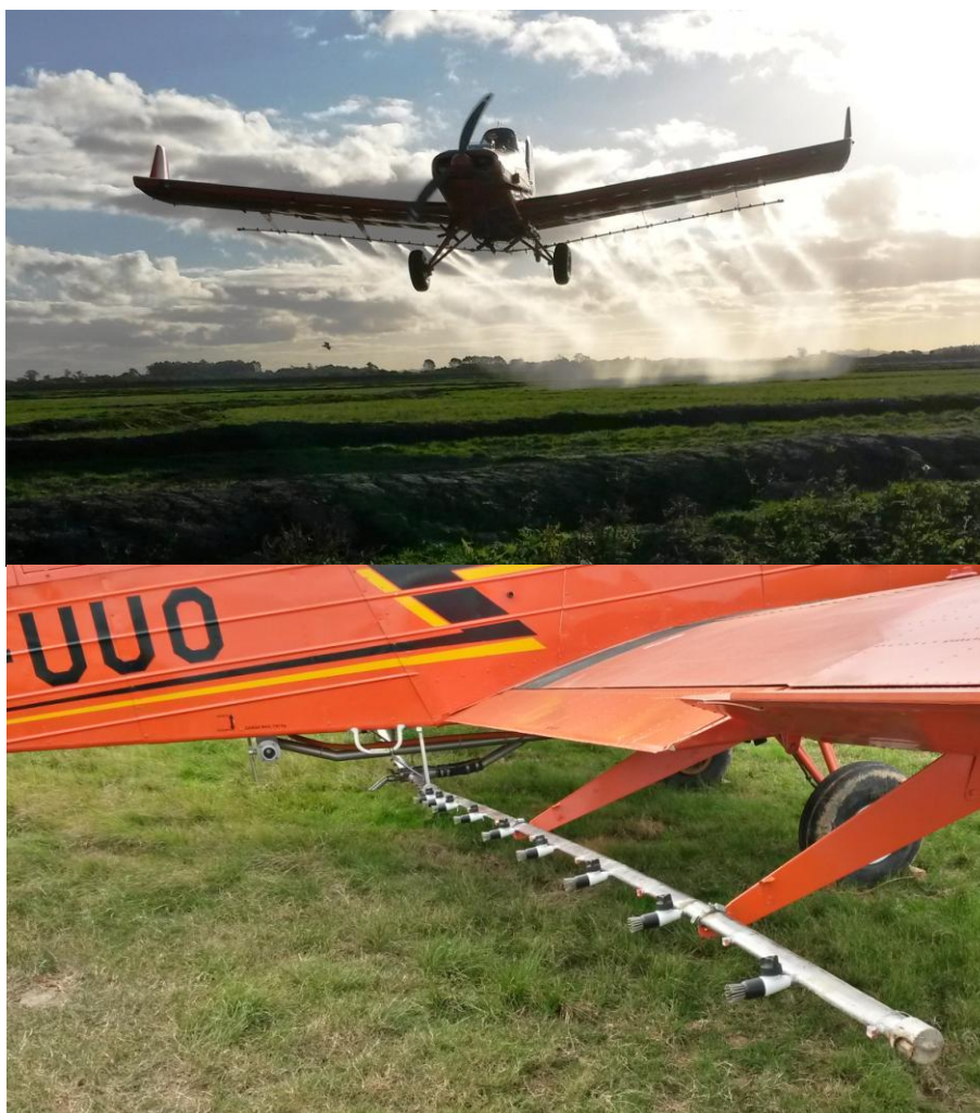
Figura 11. Aeronave Ipanema aplicando com bicos STOL ULD e detalhe do arranjo dos bicos na barra de pulverização.
