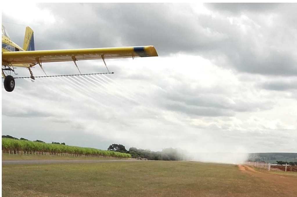
Figura 4. Aplicação de água 30 L/ha com bicos STOL ULD sobre a pista.
